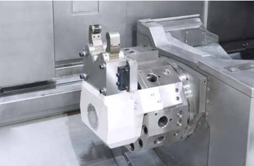
Der Revolver kann mit der Lünette gedreht werden (Die Anzahl der Montagewerkzeuge wird begrenzt).
