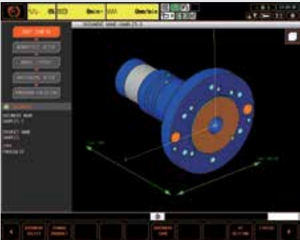
Importieren eines 3D-CAD-Modells
