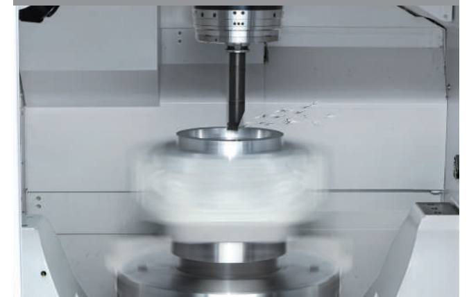
Außen, Innenausdrehen und Seitenflächenbearbeitung
