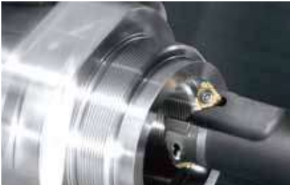
Gewindeschneiden mit Flash-Tool-Werkzeughalter
