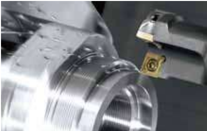
Außendrehbearbeitung mit Flash-Tool-Werkzeughalter
