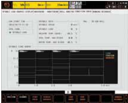
▲ Zustandskontrolle Die Temperatur sowie die Motorlast kann angezeigt werden.
