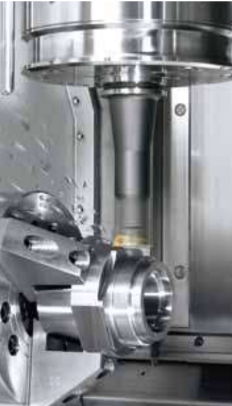
Fräsen mit Flash-Tool-Werkzeughalter
