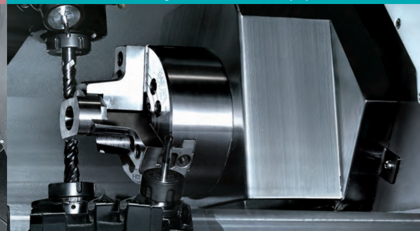
Fräsen mit Ausgleichsschnitt an der Hauptspindel
