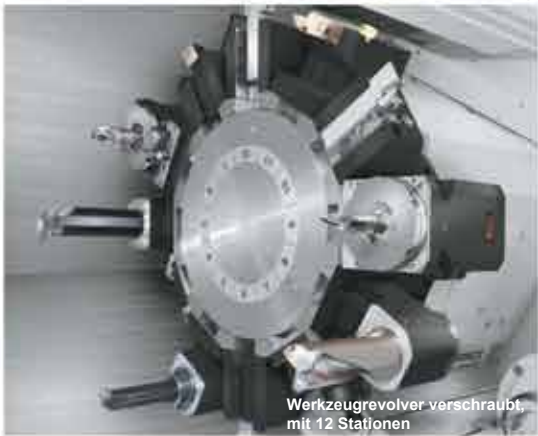
Trommelrevolver mit 12 Stationen für verschraubte Werkzeughalter (2 Achsen)
