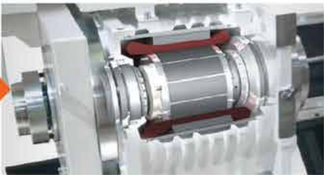
Minimale Schwingungen dank integriertem Spindelmotor
