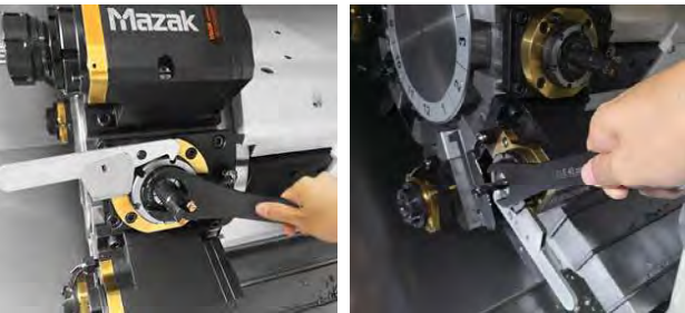
Der Einhandschlüssel kann leicht unter Federbelastung angezogen werden
